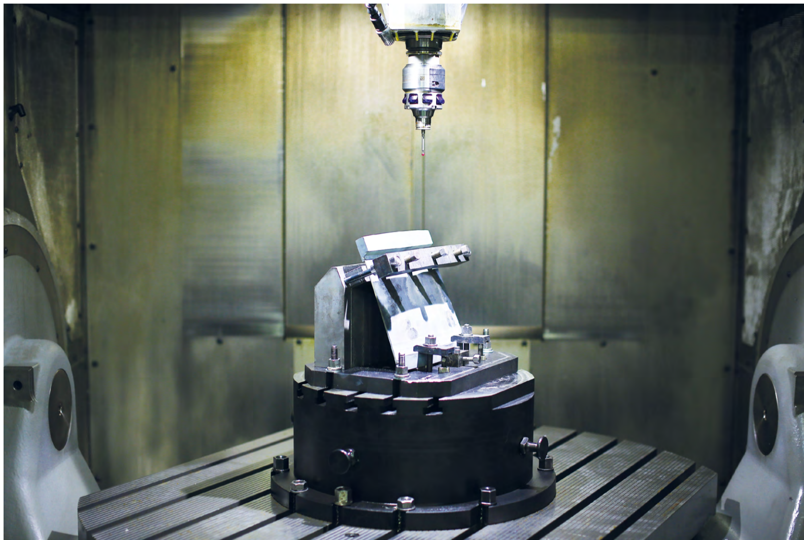
Современные станки с пятиосевой обработкой
