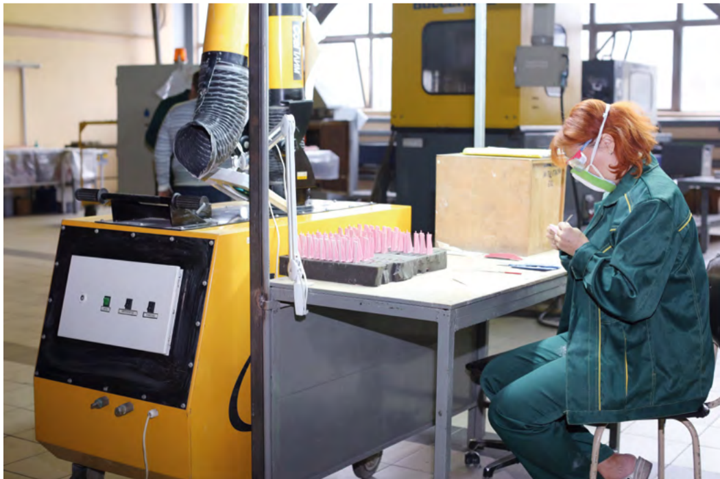
Зачистка прокаленных керамических стержней для отливок рабочих лопаток
