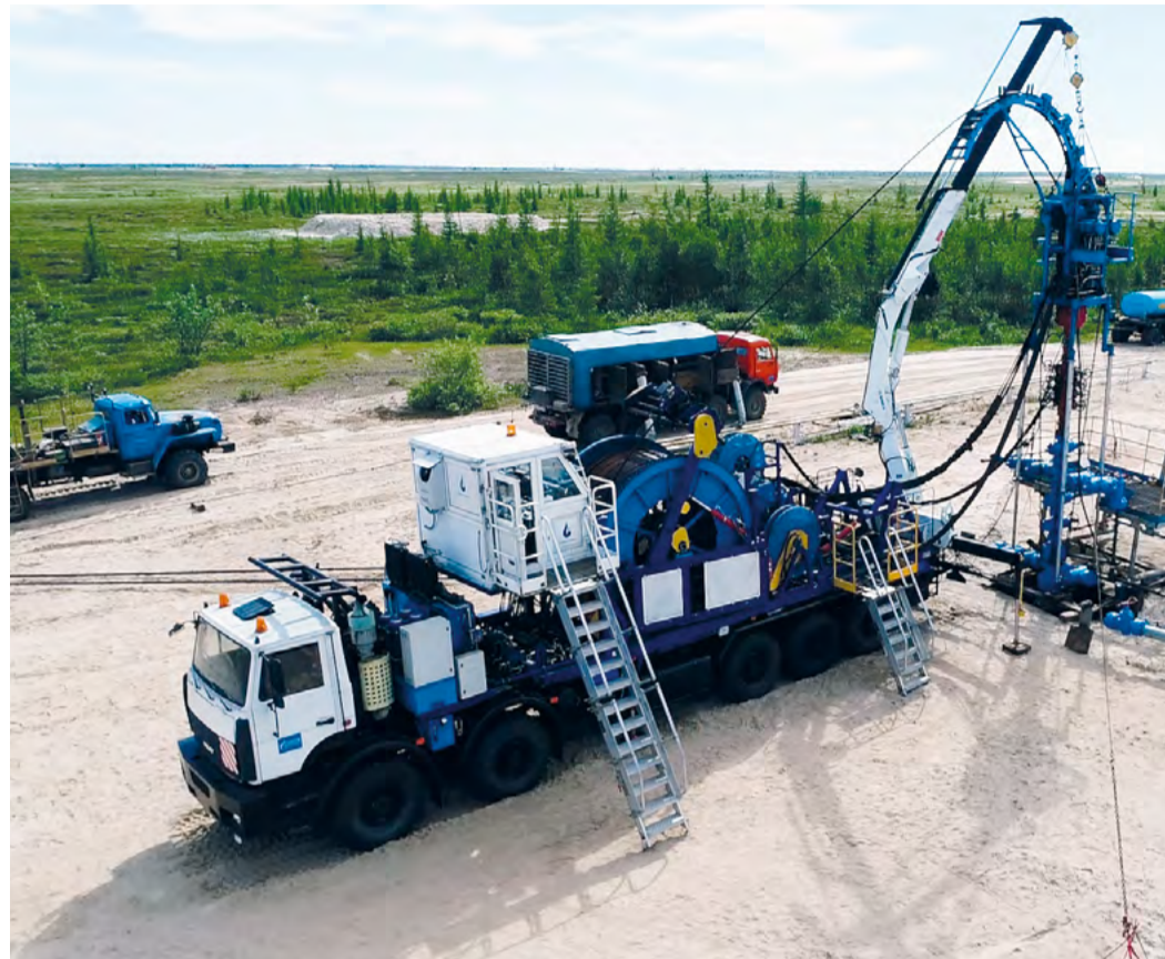
Среди новой техники, поступающей в филиалы предприятия – современные колтюбинговые установки УКРС-30 отечественного производства
