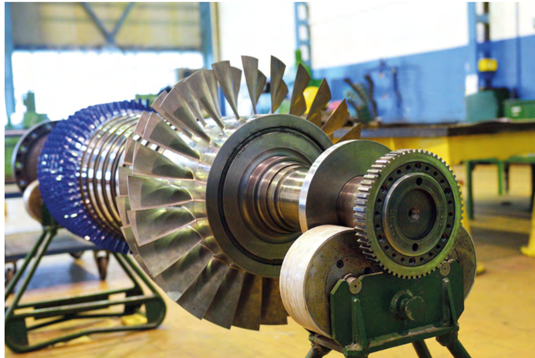
Ремонт ротора ОК-ТВД PGT-10
