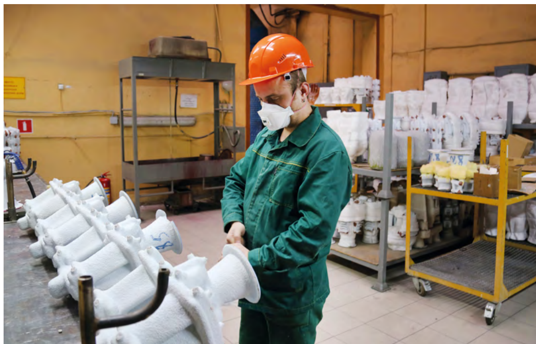
Подготовка керамических литейных форм к заливке металлом
