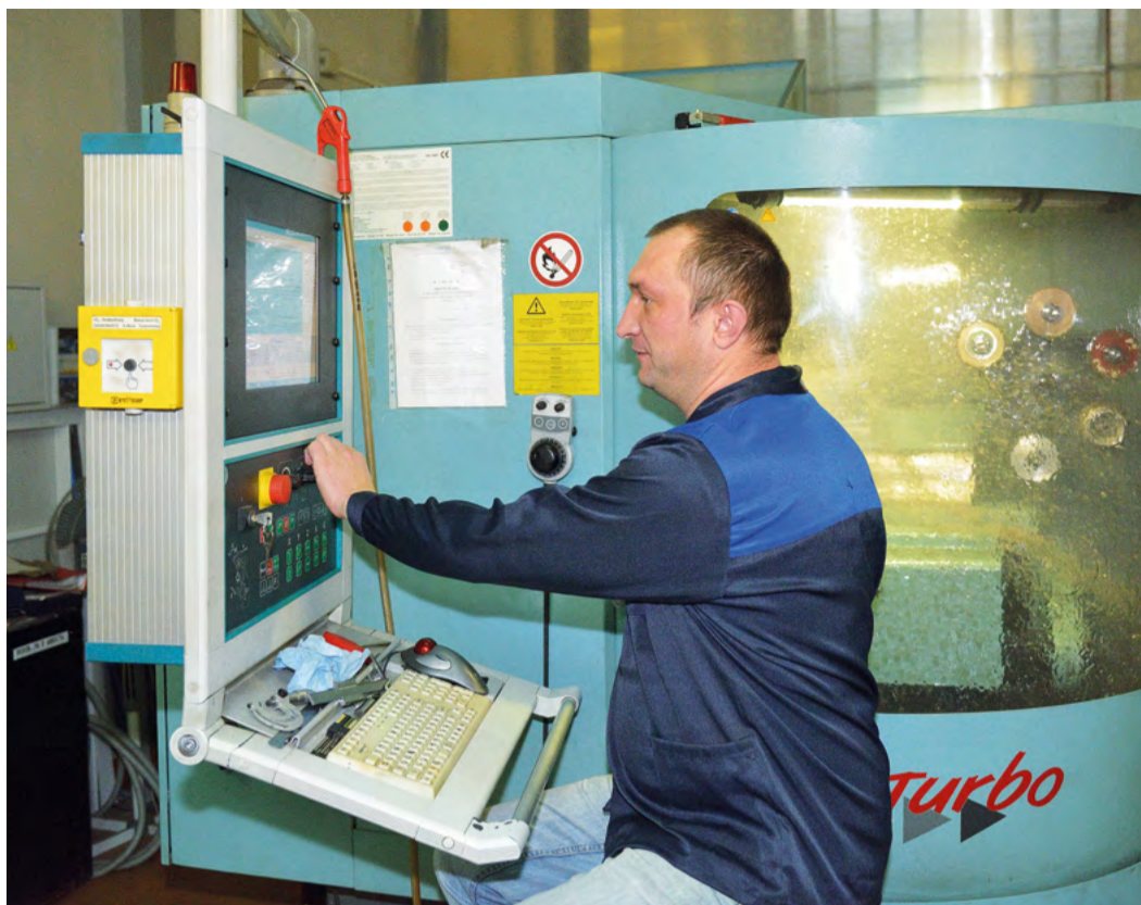
Изготовление и переточка специального инструмента на станке S20 Turbo
