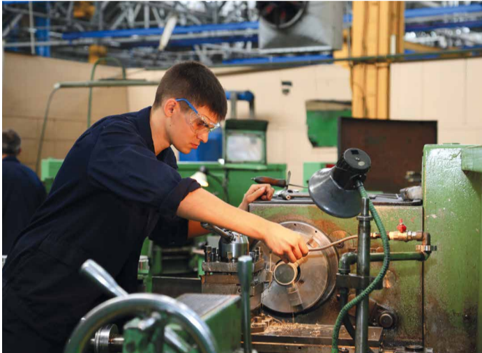
Рабочий ПАО «ТМ» обрабатывает наружную поверхность заготовки
