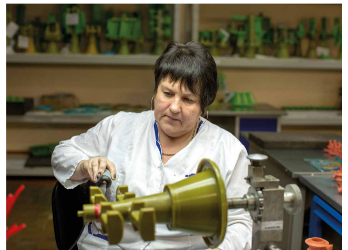
Начало операции сборки модельных блоков на заводе «Турбодеталь»
