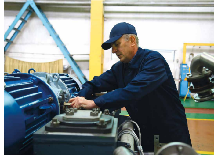
Рабочий ПАО «ТМ» монтирует стартеры на раму двигателя
