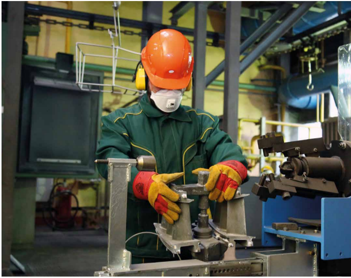
Рабочий завода «Турбодеталь» устанавливает блок отливок нарезной станок
