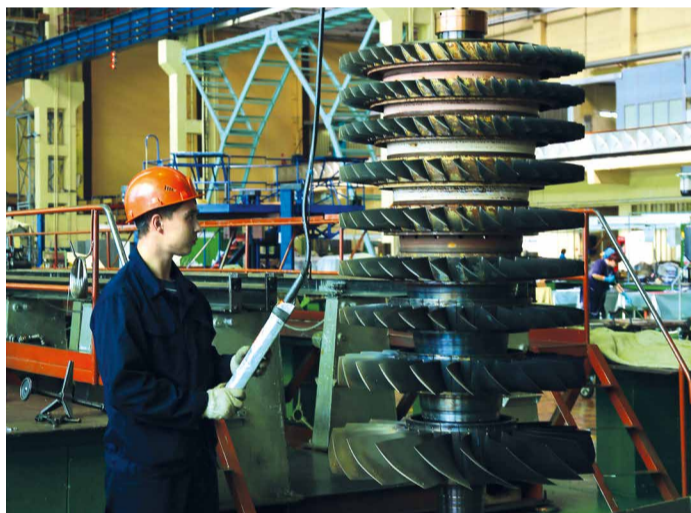
Перемещение ротора компрессора в цехе ПАО «ТМ»
