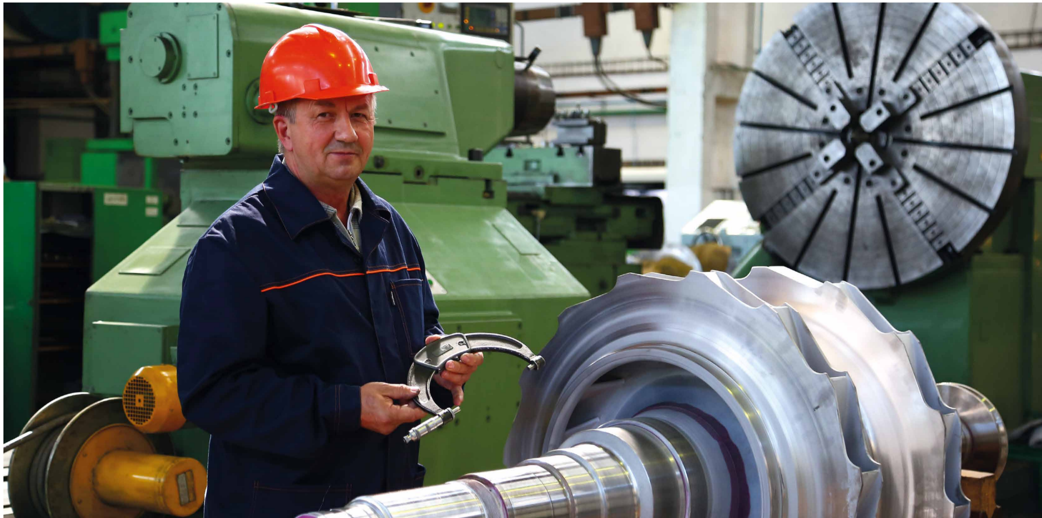
Рабочий завода «Ротор» выполняет контроль ротора центробежного нагнетателя
