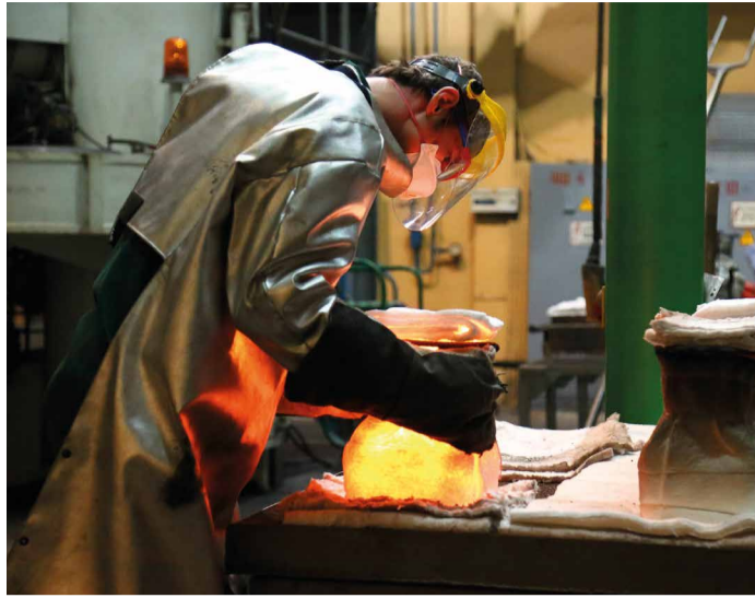
Рабочий завода «Турбодеталь» устанавливает залитый блок для охлаждения
