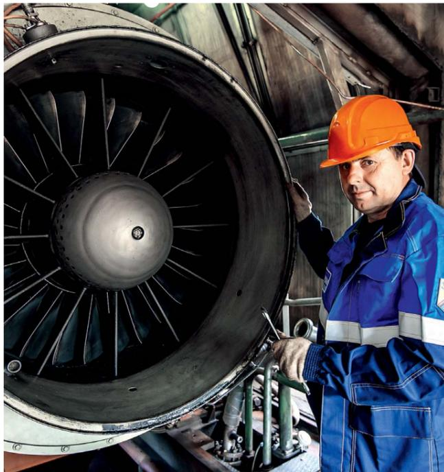
Слесарь-ремонтник 5-го разряда Владимир Голыбин осматривает входной направляющий аппарат авиационной турбины НК-16СТ перед демонтажем. Визуально он должен убедиться в отсутствии посторонних предметов, следующий этап – проверка эндоскопом. Если повреждений и лишних элементов не будет обнаружено, составляется акт и турбина допускается к пуску.
