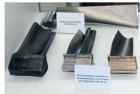
Стадии изготовления рабочих лопаток из штамповки
