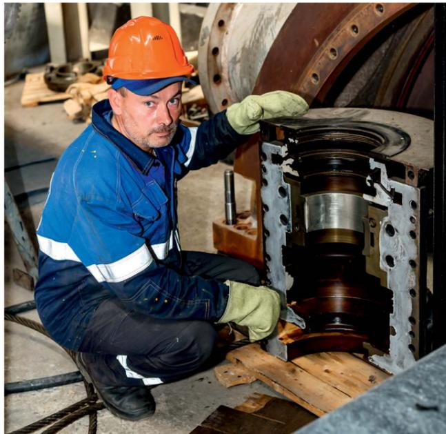
Александр Кидяев чистит разъем подшипника осевого компрессора от герметика. Затем он измерит зазоры и, если они соответствуют нормативным значениям, тогда подшипник установят на место. В случае каких-либо отклонений его отправят в ремонт на перезаливку баббитового слоя и проточку.
