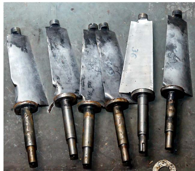
Эти лопатки уже демонтировали. Даже обывателю видны повреждения пера лопаток в виде их деформации от попадания в проточную часть постороннего предмета. В таком состоянии агрегат эксплуатировать нельзя, иначе впоследствии из строя начнут выходить другие детали и механизмы ГПА.
