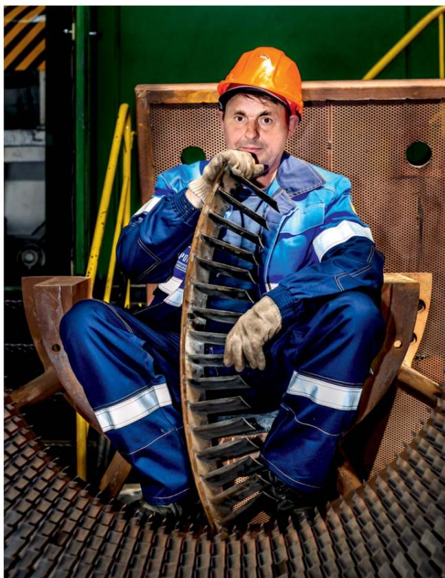
Владимир Голыбин демонтирует поврежденные статорные лопатки осевого компрессора. Затем каждую лопатку предстоит извлечь из посадочного места, всего 480 штук. На их место будут установлены новые лопатки, произведенные на заводах холдинга ООО «Газпром центрремонт».
