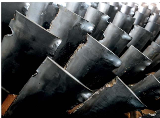
Аварийный ротор осевого компрессора турбины высокого давления (ОК-ТВД). В осевой компрессор попала лопатка
