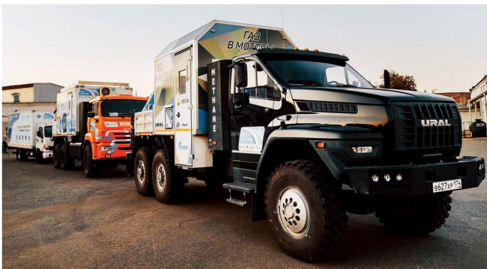
Автомобили, работающие на газомоторном топливе.
