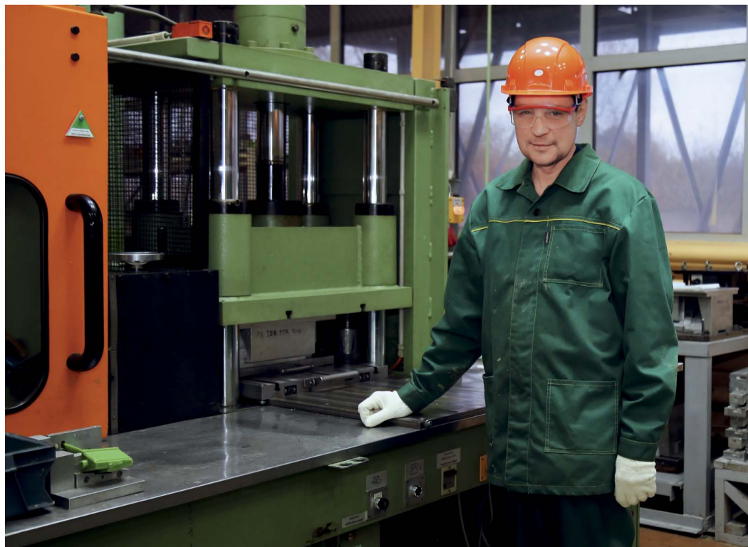
Запрессовка моделей отливки
