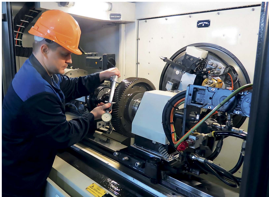
Замер делительного диаметра зубчатого колеса
