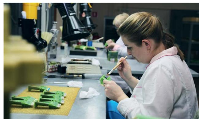
После охлаждения восковую модель отливки извлекают из оснастки. Далее восковые модели направляются для подготовки к сборке в литейные модельные блоки, где удаляются облои и закрываются технологические отверстия.
