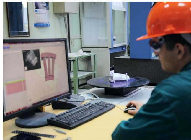
Для определения годности отливок выполняются операции радиографического контроля на полноту удаления керамического стержня и контроля геометрических параметров, который производится сравнением теоретических 3D-моделей отливок с оцифрованным объемным изображением реальных литых заготовок.
