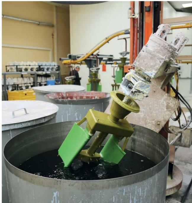
Собранные модельные блоки поступают на роботизированную линию для нанесения огнеупорного состава и изготовления литейной формы – керамической оболочки. Здесь проводится операция обезжиривания блоков в целях обеспечения смачиваемости керамической суспензией поверхностей восковой модели и модельного блока.
