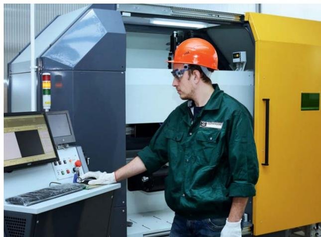
Зачистка больших партий керамических стержней производится на лазерной установке высокой производительности. Луч лазера специальной управляющей программы обходит всю поверхность керамического стержня, удаляя облои, технологические перемычки, и скругляет острые кромки стержня.
