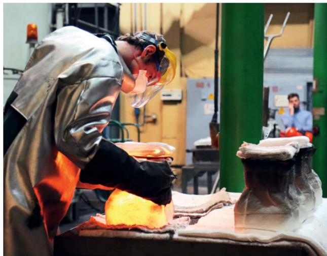
Заливка осуществляется в вакуумной плавильно-заливочной установке подготовленным жидким сплавом. Залитую металлом форму после кристаллизации сплава извлекают и устанавливают на стол для охлаждения.
