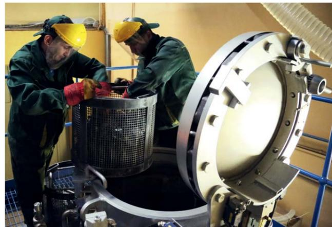
Полученные отливки направляются на операцию удаления керамических стержней.
