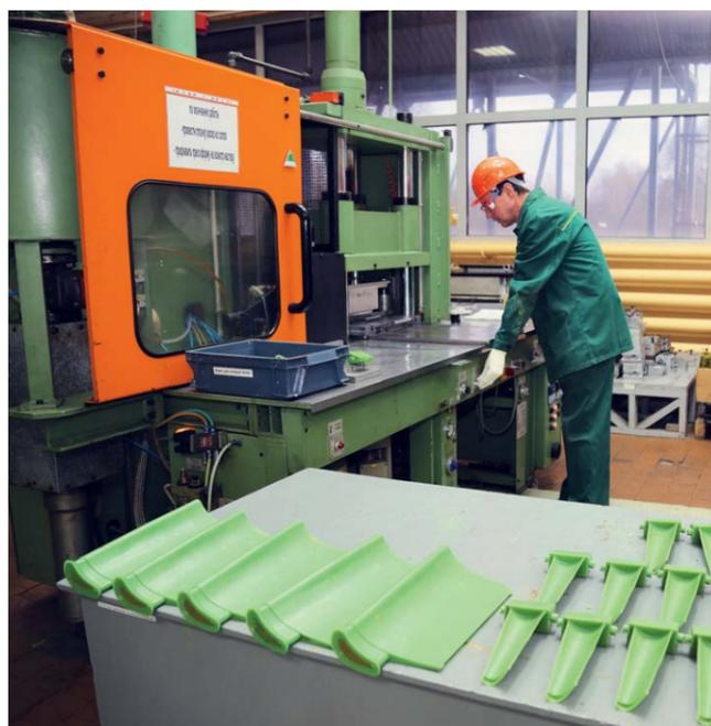
Изготовление восковых моделей производится запрессовкой полимерной композиции в формообразующую оснастку с установленным в нее керамическим стержнем. При запрессовке пластиковая модельная масса заполняет полость оснастки, обтекая при этом керамический стержень.
