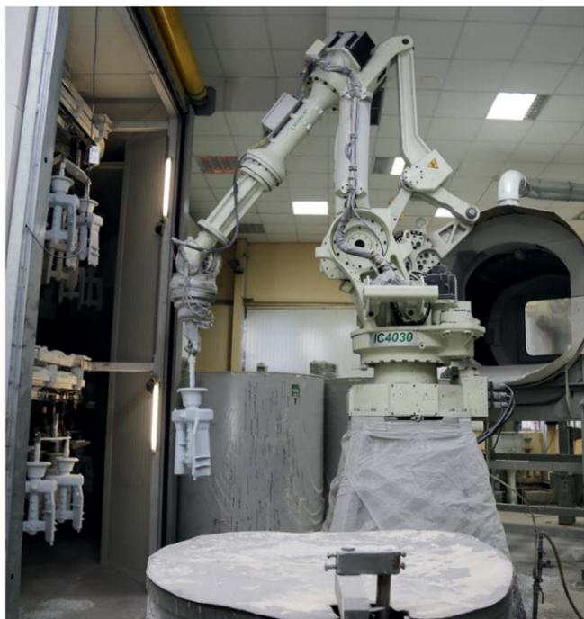
Изготовление керамических форм-оболочек производится последовательным (послойным) нанесением керамики на модельный блок с сушкой каждого слоя.
