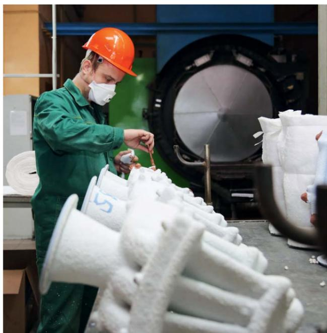
Количество слоев керамической формы различно для каждого блока и зависит от массогабаритных размеров отливки и параметров заливки жидким металлом. После сушки последнего слоя керамической оболочки и вскрытия литейной чаши формы-оболочки устанавливаются в корзину бойлерклава, где под действием температуры и давления пара модельная композиция расплавляется и удаляется через вскрытую литейную чашу. Остатки модельной массы выводятся из полости формы-оболочки при прокатке.
