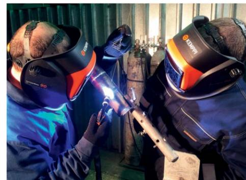
Ручная аргонодуговая сварка неплавящимся электродом
