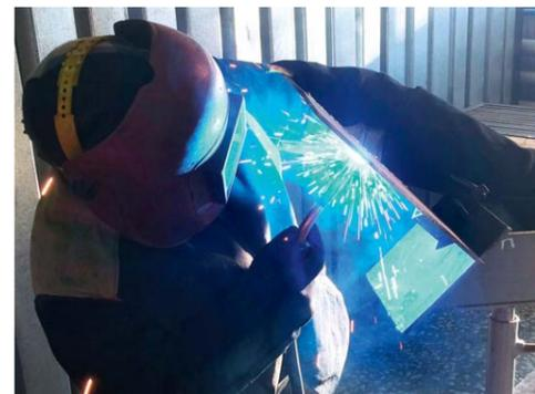
Механизированная сварка плавящимся электродом в среде активных газов и смесей
