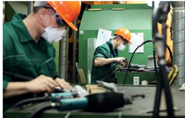
Для удаления остатков керамической формы с наружных поверхностей отливки проходят струйно-абразивную обработку. В местах обрезки остатки от литников удаляются с помощью пневматических бормашинок. Здесь же производится зачистка обоя отливок.
