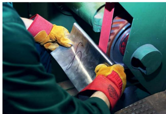
Последним этапом является финишная и полуфинишная абразивная обработка отливок. Производится доводка газодинамических профилей для соответствия требованиям конструкторской документации, а также для увеличения класса чистоты поверхности.
