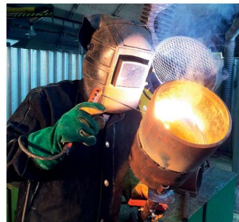
Ручная дуговая сварка покрытыми электродами
