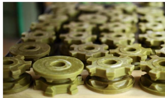
Данные блоки также изготовлены из модельных масс, они состоят из отдельных элементов литниково-питающих систем, обеспечивающих равномерное затвердевание металла после заполнения им литейной формы.
