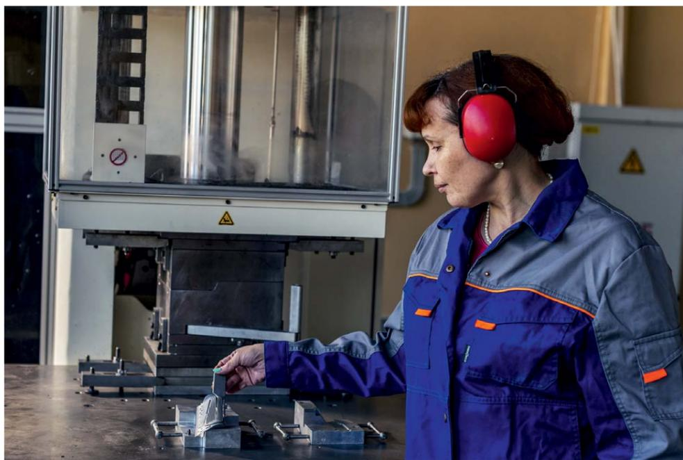
Керамический стержень отливки рабочей лопатки 1-й ступени ТВД ГПА SGT-600 «Балтика-25»
