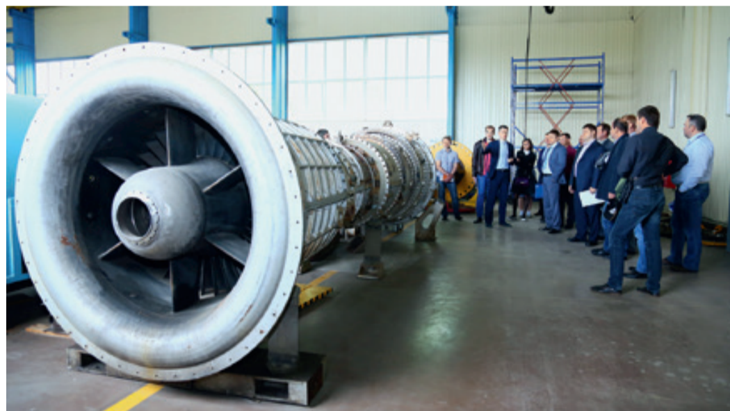
Полномасштабный тренажер газотурбинного двигателя судового типа ДР59Л
