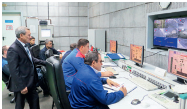
Пульт управления испытательной станции в цехе № 35
