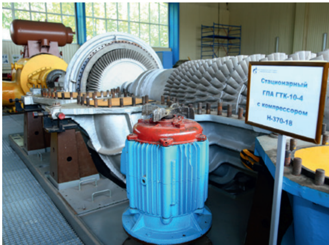
Полномасштабный тренажер газоперекачивающего агрегата ГТК-10-4
