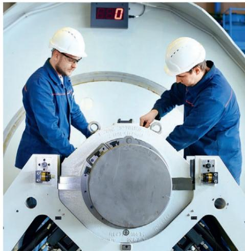
Разгонно-балансировочный стенд. Филиал ОАО «Газэнергосервис» – завод «Турборемонт»
