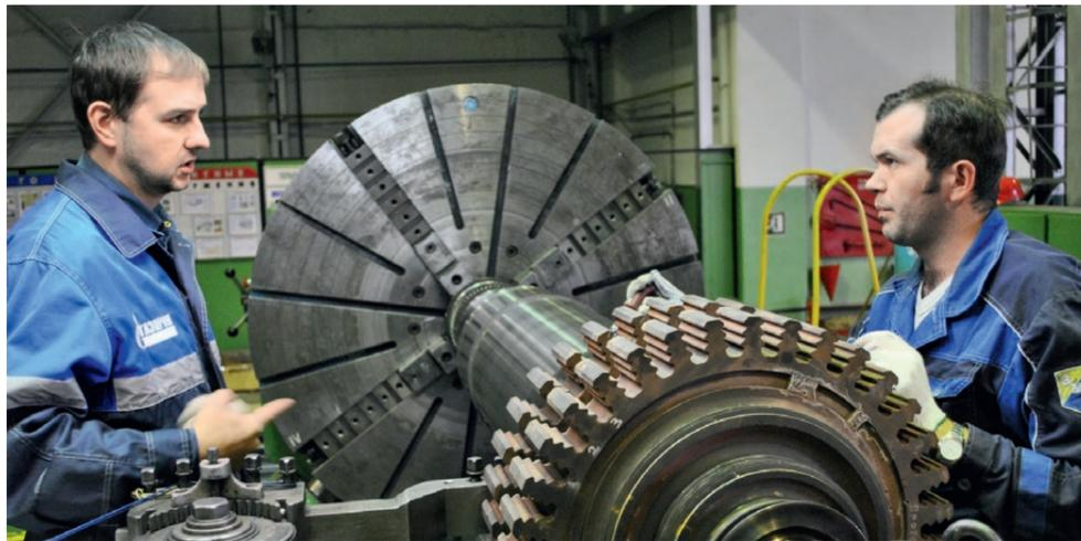
Восстановление поверхности роторов турбин. ПТУ «Надымгазремонт» филиала «Югорский» АО «Газпром центрэнергогаз»
