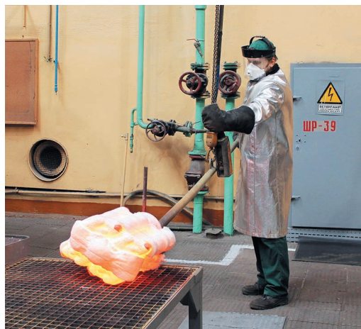
Прокалка форм перед заливкой сплавом
