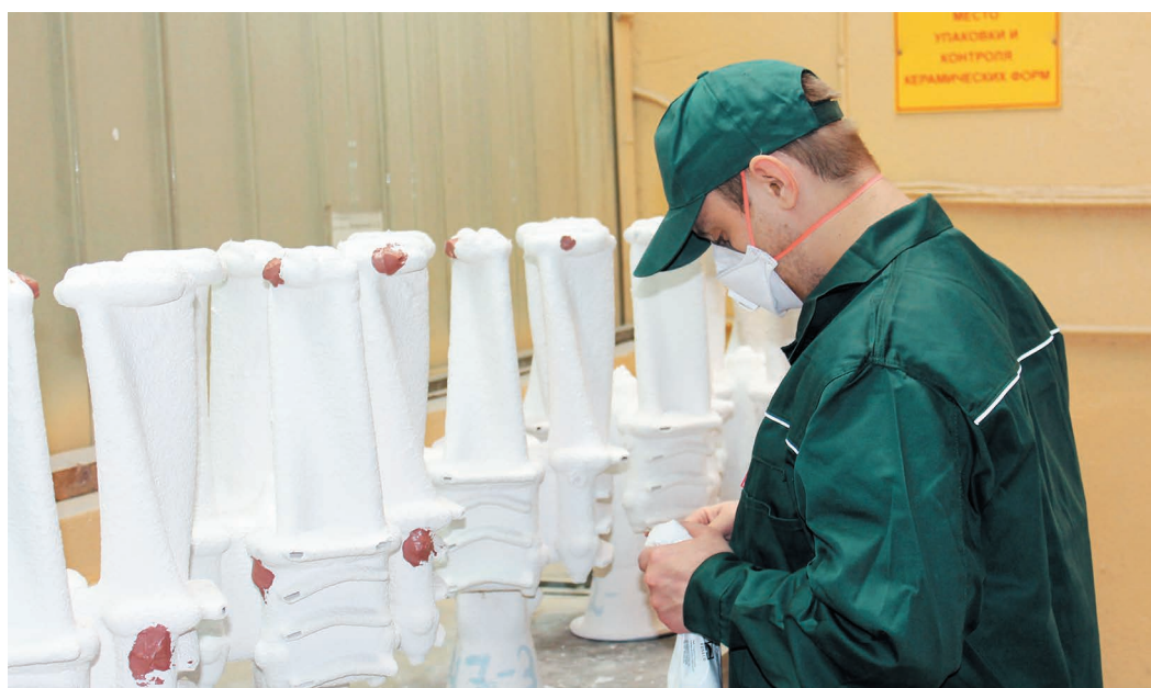
Подготовка и контроль керамических форм
