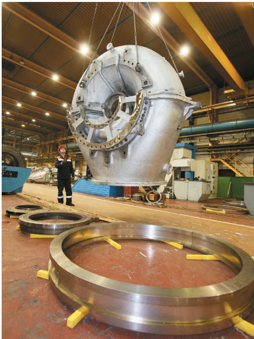
Транспортировка корпуса турбины ГТК-10-4 (филиал ОАО «Газэнергосервис» – завод «Турборемонт»)
