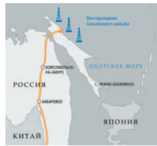
Морской переход через пролив Невельского, газопровод Сахалин – Хабаровск – Владивосток Длина судоходного хода – 5–6 км Длина шельфовой зоны – 25–27 км Количество ниток – 2 Расстояние между нитками – 30–50 м Максимальная глубина – 30 м
