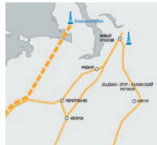
Морской переход через Байдарцкую губу, газопровод Бованенково – Ухта Протяженность – 70 км Количество ниток – 2 Расстояние между нитками – 30–50 м Максимальная глубина – 30 м
