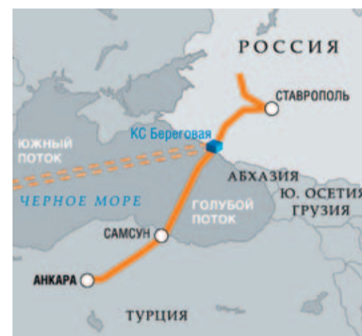
Морской переход «Голубой поток» Протяженность – 396 км Диаметр трубопроводов – 610 мм Толщина стенок – до 41 мм Максимальная глубина – 2150 м
