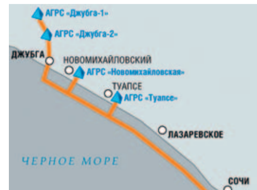
Морской переход Джубга – Лазаревское – Сочи Протяженность – 171,6 км Диаметр трубопроводов – 530 мм Толщина стенок – 15 мм Максимальная глубина – 80 м
