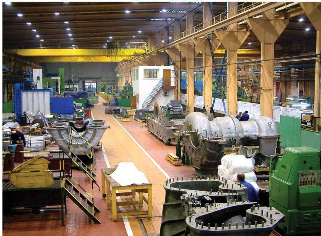
Участок ремонта турбоблоков ГТК-10-4 на заводе «Турборемонт»
