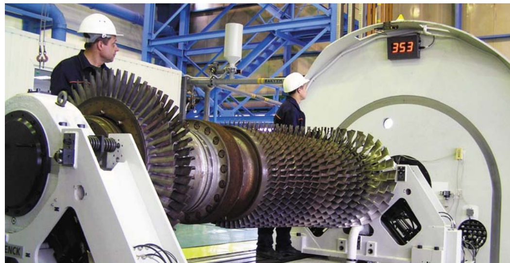
Разгонно-балансирующий стенд на базе завода «Турборемонт» – филиала ОАО «Газэнергосервис»
