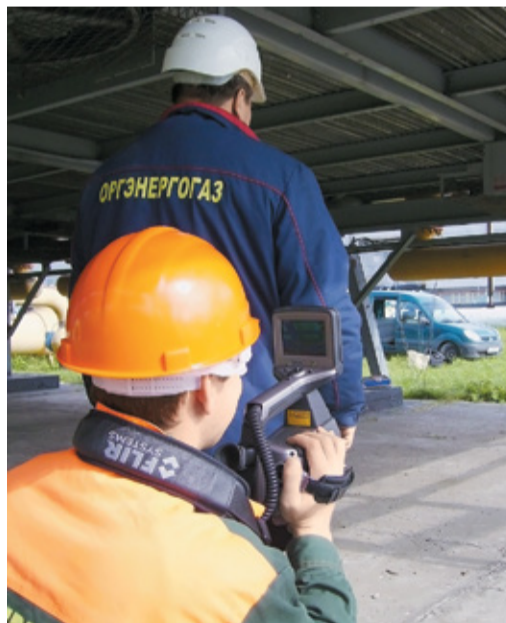
Проведение тепловизионного контроля АВО газа
