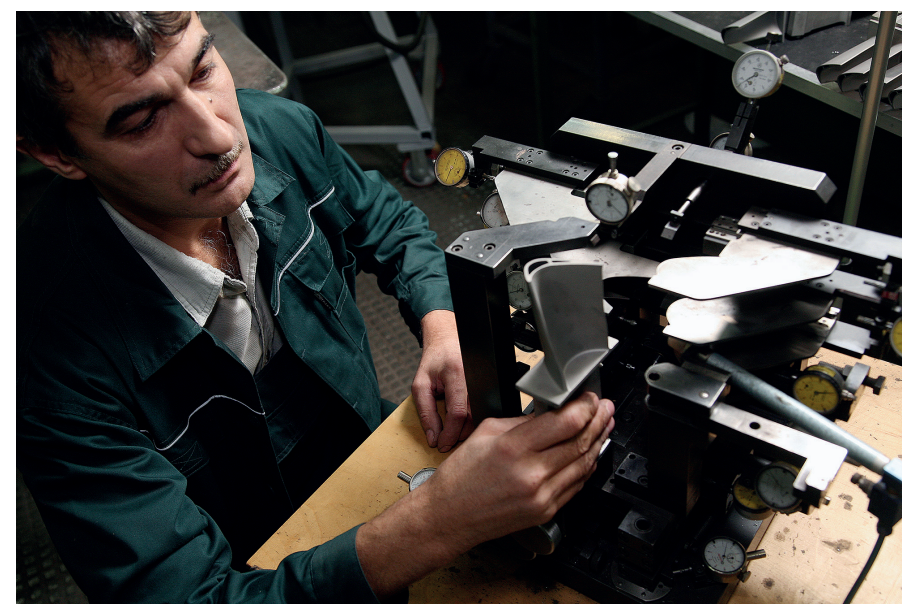
Шаблонирование отливок в контрольном приборе. Филиал ОАО «Газэнергосервис» — завод «Турбодеталь»
