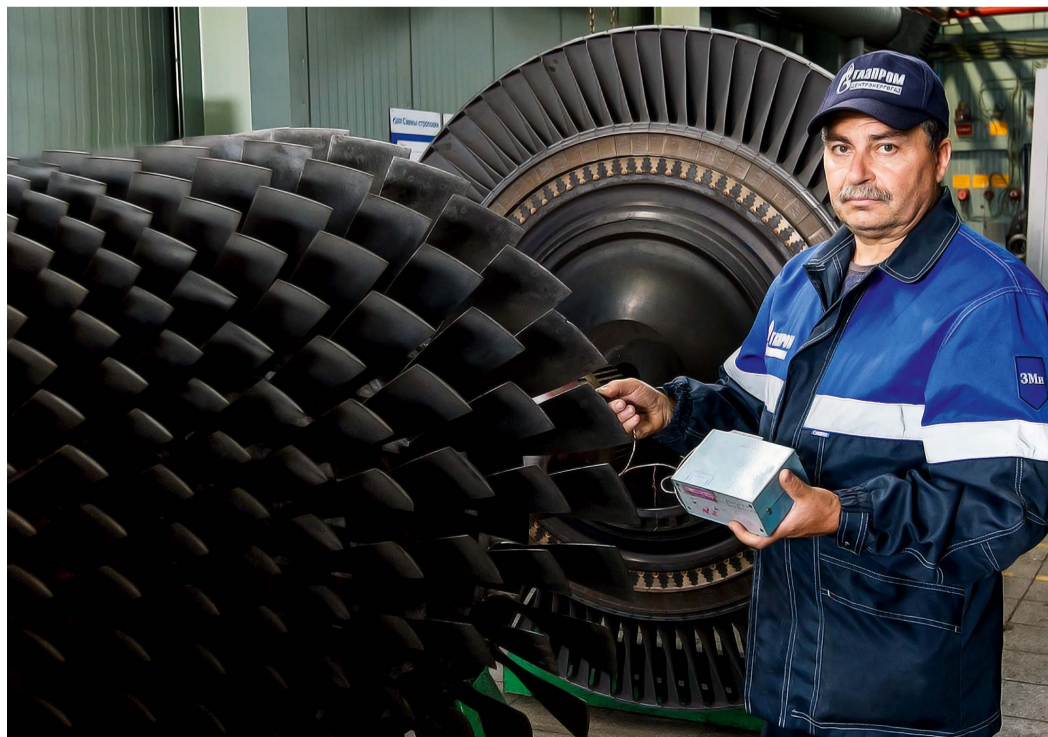
Дефектоскопия методом неразрушающего контроля
