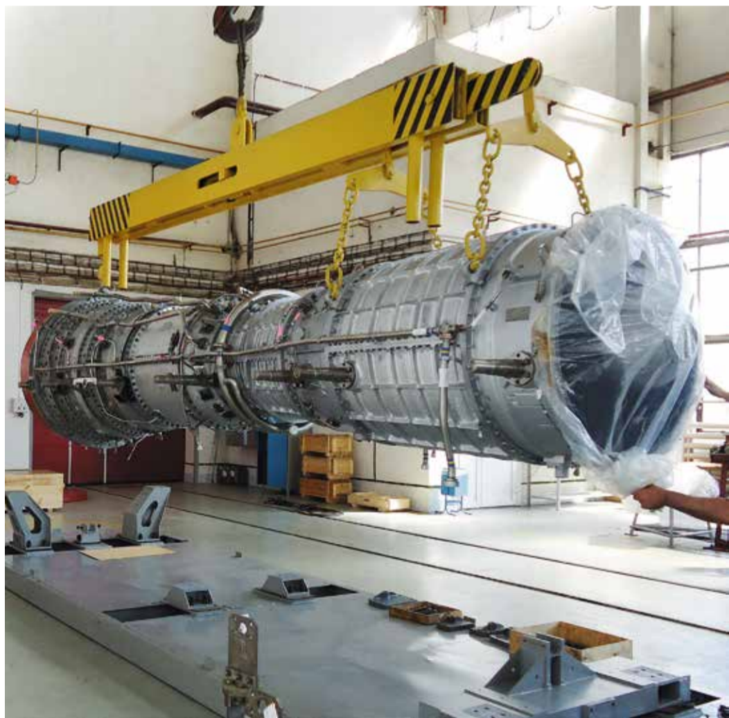
Двигатель судового типа ДР-59Л
