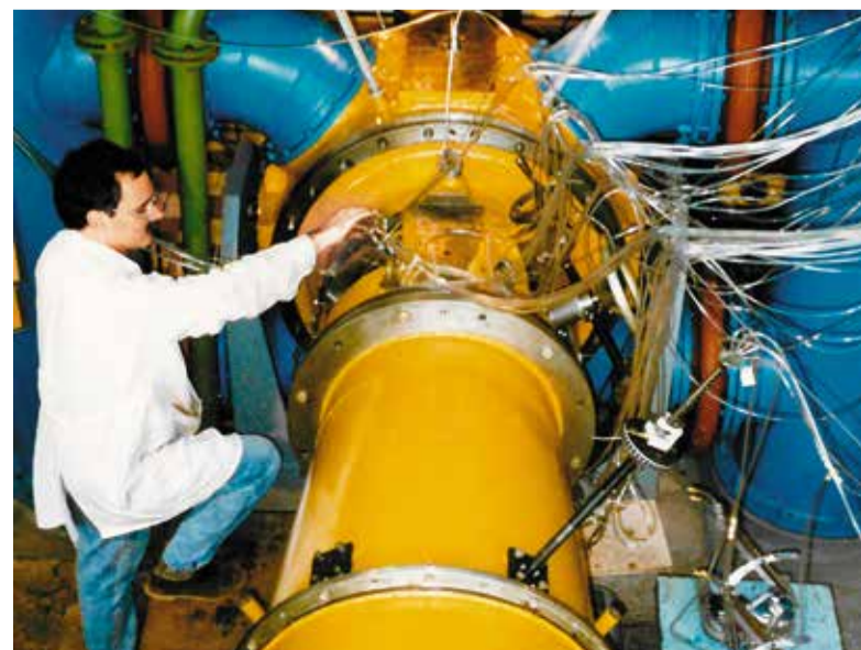
Экспериментальный стенд для обработки турбинных ступеней ГТУ. 1996 год
