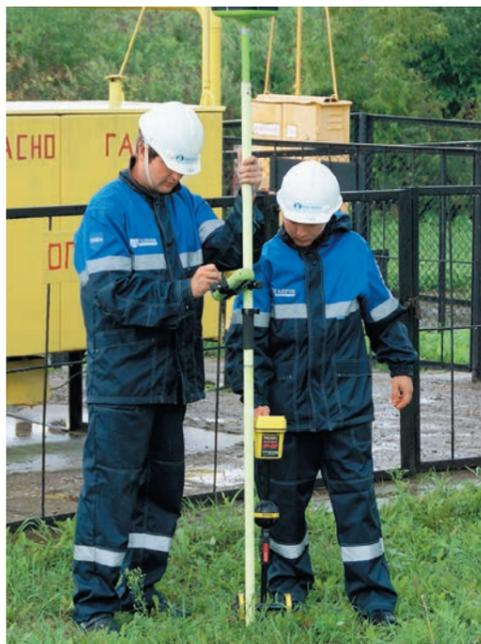
Определение пространственного положения трубопровода
