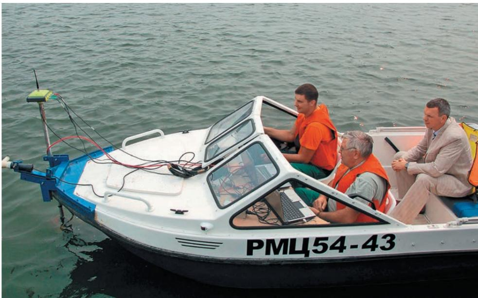
Определение технического состояния подводного перехода с помощью приборного комплекса
