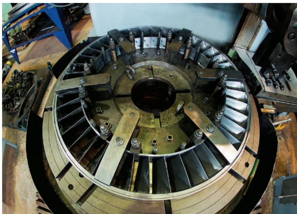
Обработка пакетов направляющих лопаток осевого компрессора ГПА
