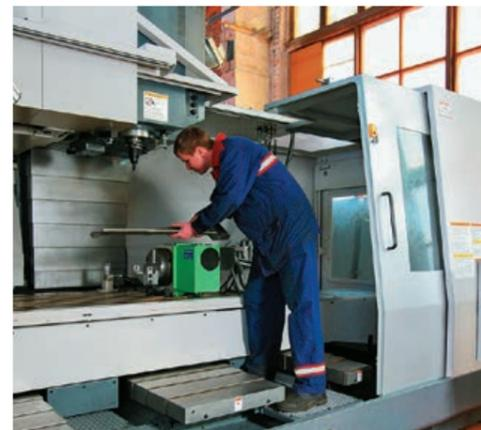
Установка лопатки в приспособление станка
