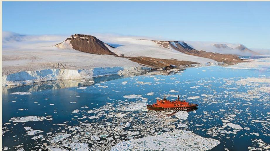
Атомный ледокол водоизмещением 23 000 тонн преодолевает лед толщиной 5 метров
