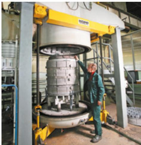
Термическая обработка изделий в вакуумной печи
