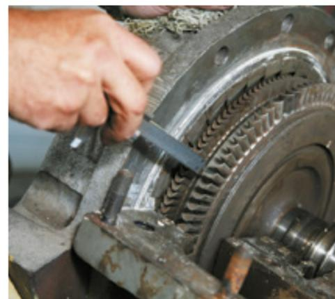
Техническое обслуживание турбодетандера
