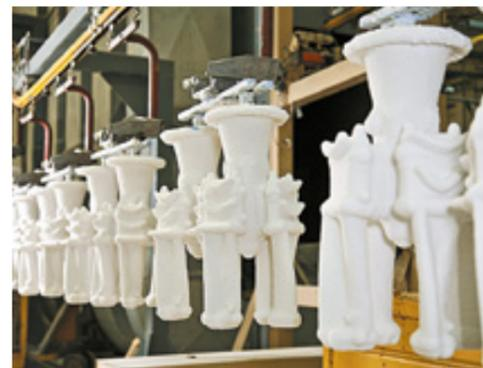
Изготовление керамических форм на роботизированном комплексе
