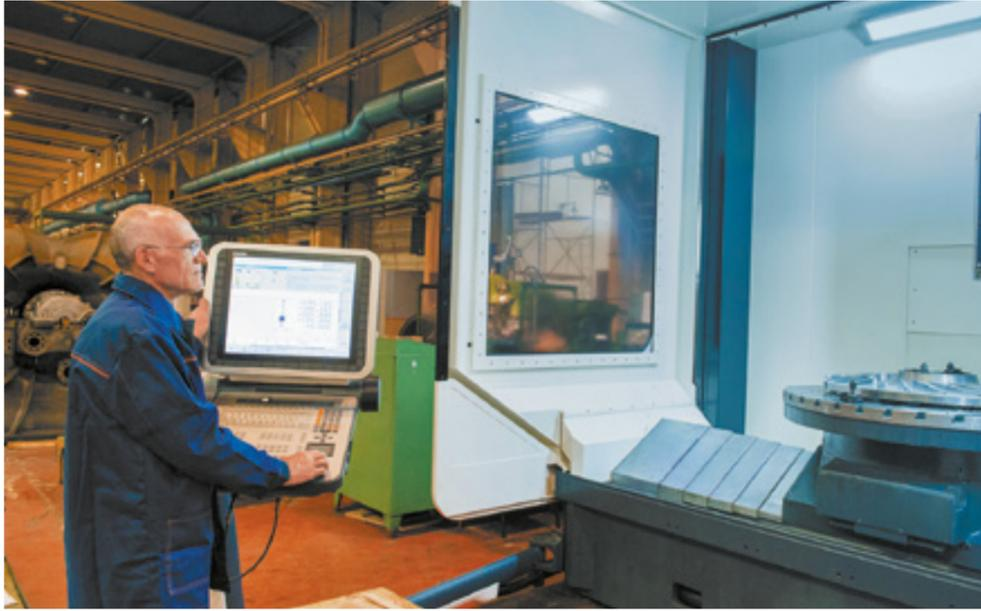
Обработка основного диска рабочего колеса нагнетателя на заводе «Турборемонт»
