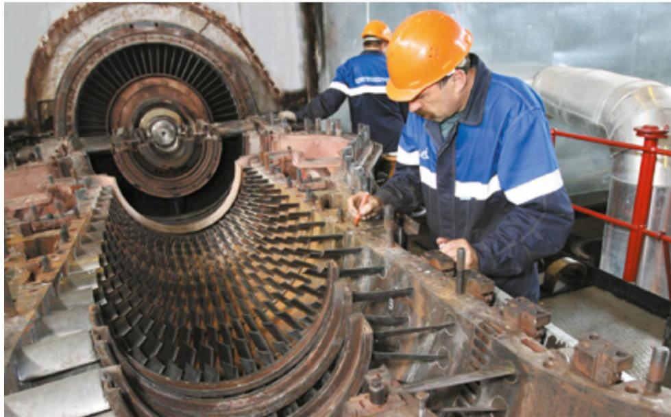
Технический осмотр горизонтального разреза корпуса осевого компрессора ГТН-25-1
