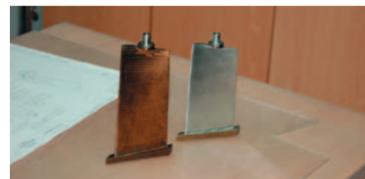
Продукция цеха – лопатки компрессора и турбины
