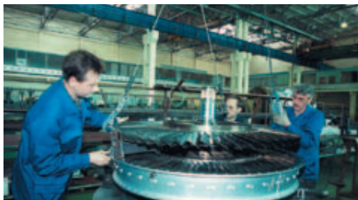
Сборка силовой турбины
