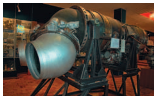
Подъемно-маршевый двигатель палубного штурмовика Як-38
